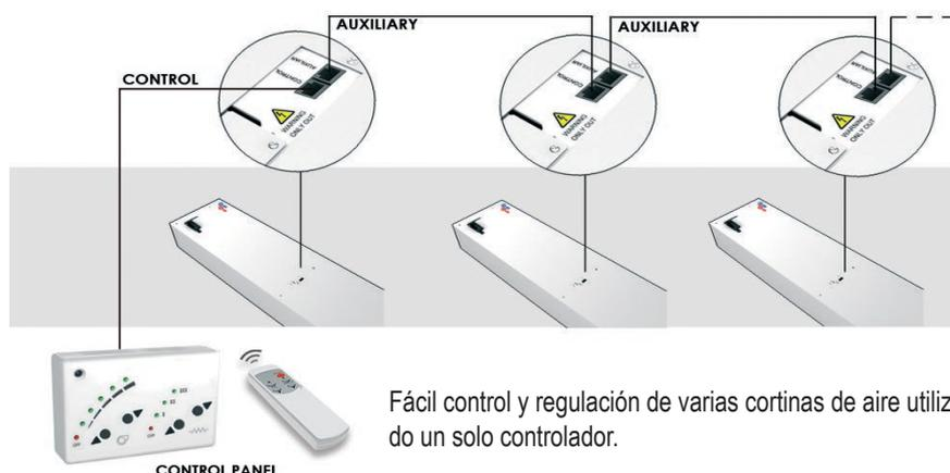
Fácil control y regulación de varias cortinas de aire utilizando un solo controlador.
